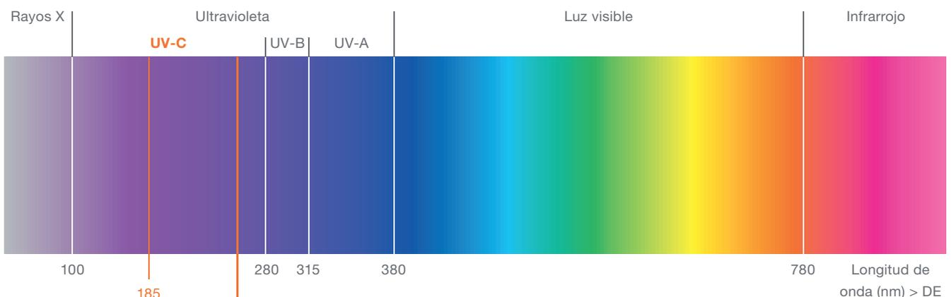
El efecto más fuerte de la radiación UV contra los patógenos se produce en las longitudes de onda alrededor de 265 nm. Al tener una alta densidad de radiación a 254 nm, los tubos UV-C de LEDVANCE están muy cerca de este pico.
