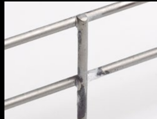
Acabado HR después de 1000 horas HR coating after 1000 hours
